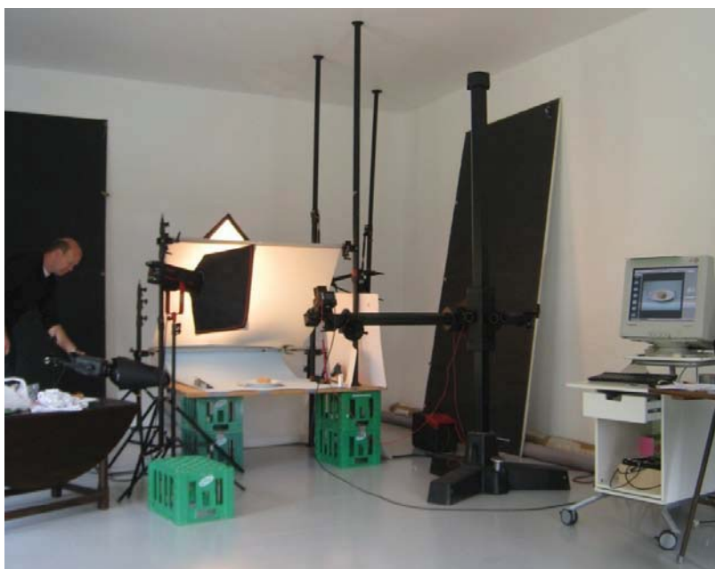
Opstilling ved 2. session i fotoatelieret. Fototårnet muliggør hurtig justering af afstand og højde. Direkte visning på computerskærm er en nødvendighed.
